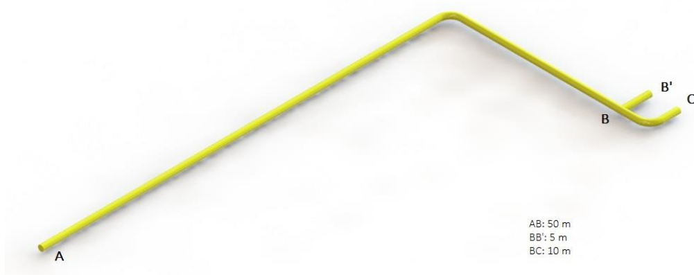
Figura 20: Isométrico da instalação industrial
