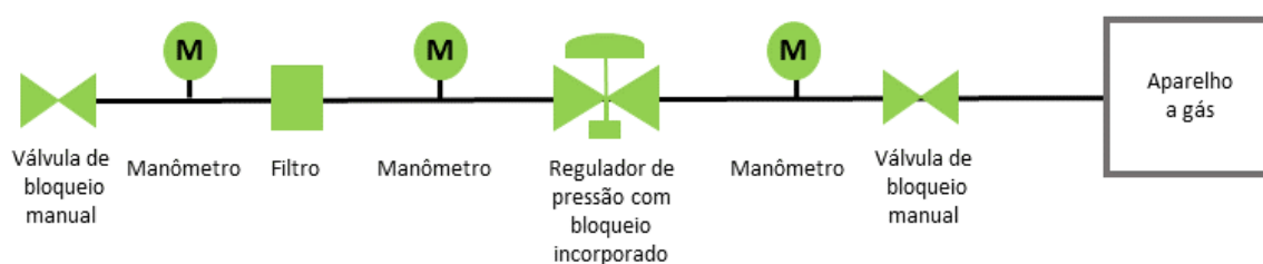
Figura 18: Representação genérica dos componentes da SIRP de cozinhas industriais e refeitórios.
